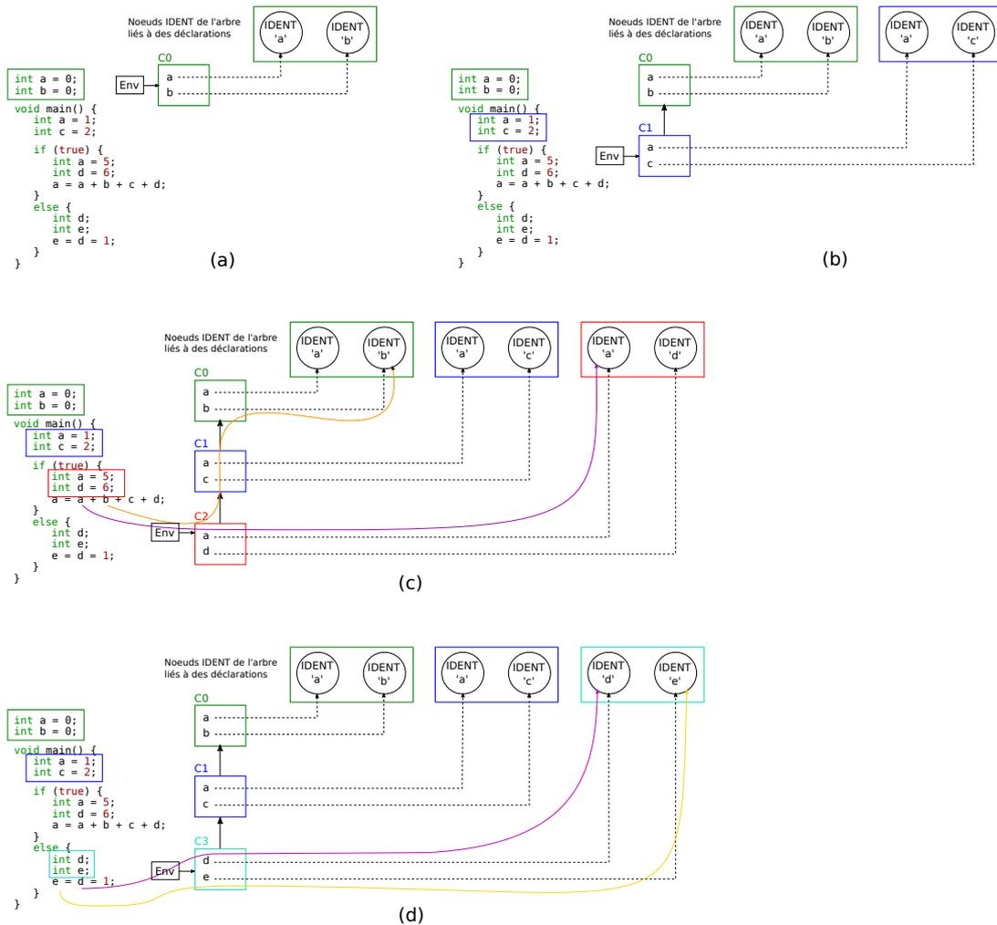
FIGURE 4 – Environnement d’analyse des différents blocs du programme
