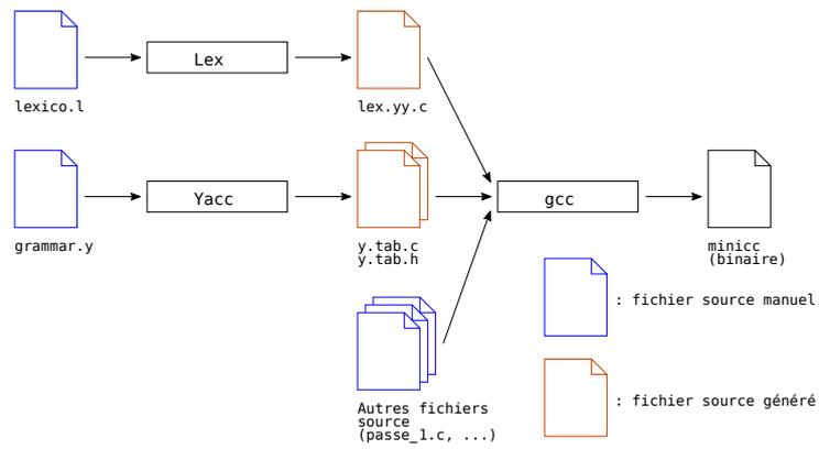
FIGURE 1 – Processus de compilation utilisant lex et yacc
